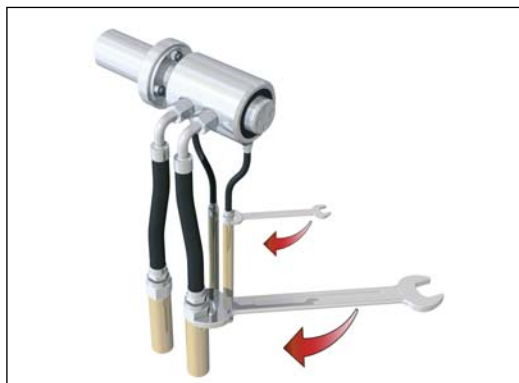
Рис. 4: Шланги проведены под углом в 90°
